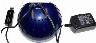
Abb. 1: Rückseite des Wöhler CDL 210 mit angeschlossenen Datenkabel und Netzteil
