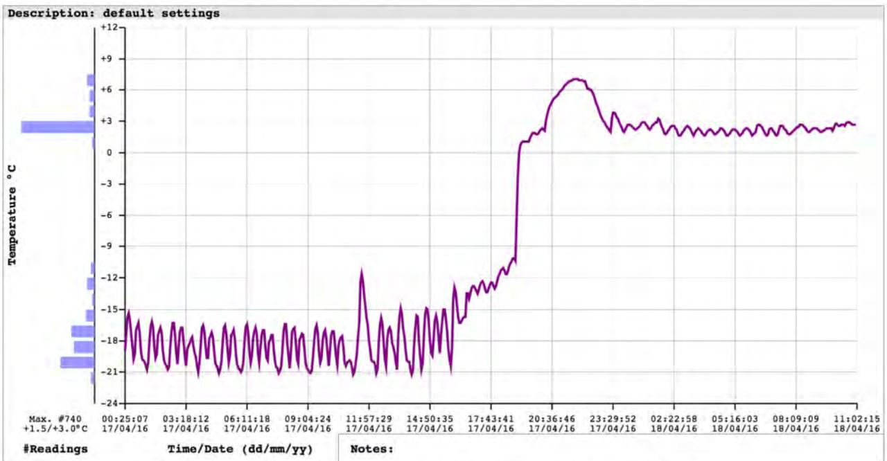
*Deze KtLcd met een nauwkeurigheid van +/-0,3°C van -80°C tot 80°C (+/-0,6°F van -10°F tot 176°F) en een oplossing van 0,01°C (°F) is gekalibreerd in de kalibratiekamer van Askey Dataloggers BV. De gebruikte referentie-apparatuur is herleidbaar naar internationale standaarden. Apparaat: RLM660004*
